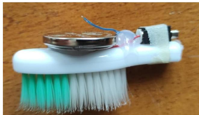
6. Pelar la punta del cable azul del motor y ubicarlo sobre la pila
