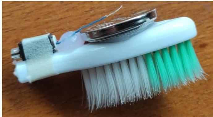
7. Fijar el cable azul pelado a la pila utilizando cinta adhesiva
