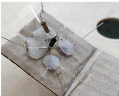
5. Luego, unir el otro extremo de la resistencia con el cable rojo del portapilas. Puede ser necesario pelar un poco el cable para lograr la unión.
