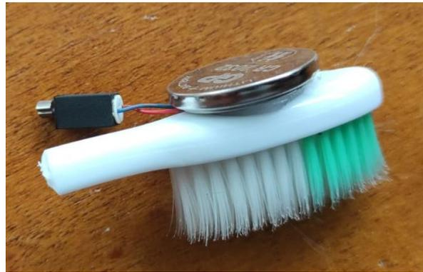
4. Fijar los cables del motor vibrador al cepillo utilizando silicón caliente, para evitar que los cables se muevan y puedan desprenderse del motor
