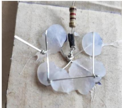
7. Unir el cable negro del portapilas a los terminales negativos, procurando que el portapilas tenga su pila y esté activado el interruptor para que los leds enciendan
